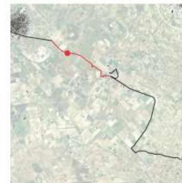
La sezione è tracciata lungo una strada vicinale di accesso ai fondi agricoli, nel comune di San Gavino Monreale. Data la bassa intensità di traffico si prevede il transito in sede promiscua con i veicoli, tramite pavimentazione del fondo stradale con stabilizzato misto cava e utilizzo di opportuna segnaletica verticale.
