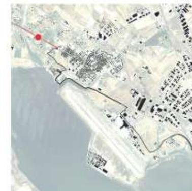
La sezione si trova lungo la Via Sulcitana, strada extraurbana nel comune di Elmas. L'itinerario si collega alla pista in sede propria già realizzata in continuità con il percorso pedonale. Si prevede la verifica del corretto dimensionamento, dello stato della pavimentazione e l'inserimento di opportuna segnaletica orizzontale.
