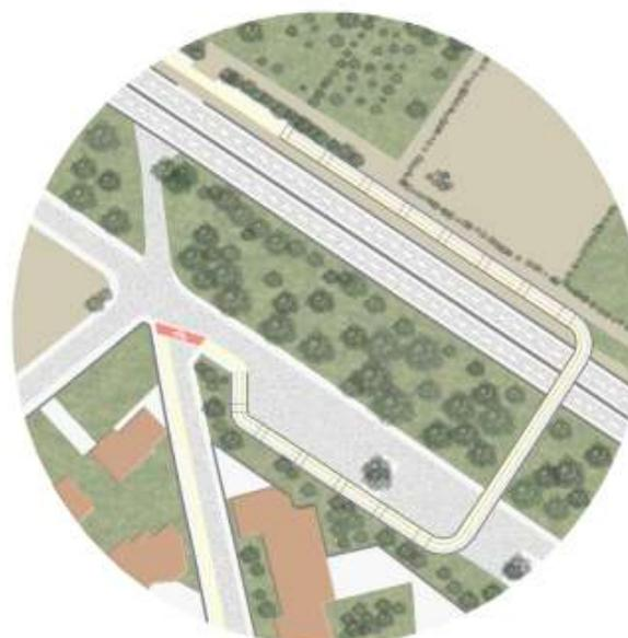
**descrizione:** attraversamento della SS130 tramite passerella ciclopedonale sopraelevata, a connessione tra percorso promiscuo e pista in sede propria
