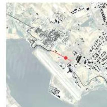
La sezione è tracciata lungo un sentiero carrabile in prossimità dell'aeroporto, nel comune di Elmas. L'intervento prevede la realizzazione di pista in sede propria non affiancata attraverso la sistemazione del fondo stradale in stabilizzato misto cava.
