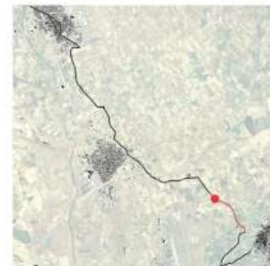
La sezione è tracciata su una strada vicinale di accesso ai fondi agricoli, nel comune di Villasor. Data la bassa intensità di traffico si prevede il transito in sede promiscua con i veicoli, attraverso la sistemazione del fondo stradale con stabilizzato misto cava e l'utilizzo di apposita segnaletica verticale.
