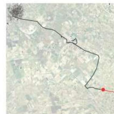
La sezione si trova su una strada vicinale di accesso ai fondi agricoli, nel comune di Samassi. Data la bassa intensità di traffico si prevede il transito in sede promiscua con i veicoli, con opportuna sistemazione del fondo stradale con stabilizzato misto cava (in base allo stato di degrado dello stesso) e utilizzo di segnaletica verticale.
