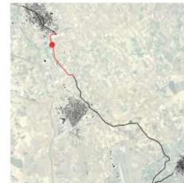
La sezione si trova su un sentiero carrabile lungo canale, nel comune di Serramanna. Data la bassa intensità di traffico, si prevede il transito in sede promiscua con i veicoli, tramite il rifacimento del fondo stradale con stabilizzato misto cava, l'inserimento di barriera laterale di protezione e opportuna segnaletica verticale.
