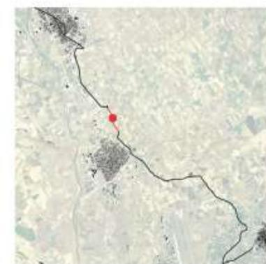
La sezione si trova su un sentiero pedonale lungo canale, nel comune di Villasor. Si prevede la realizzazione di pista in sede propria attraverso il rifacimento della pavimentazione con stabilizzato misto cava e l'inserimento di barriere di protezione a lato.
