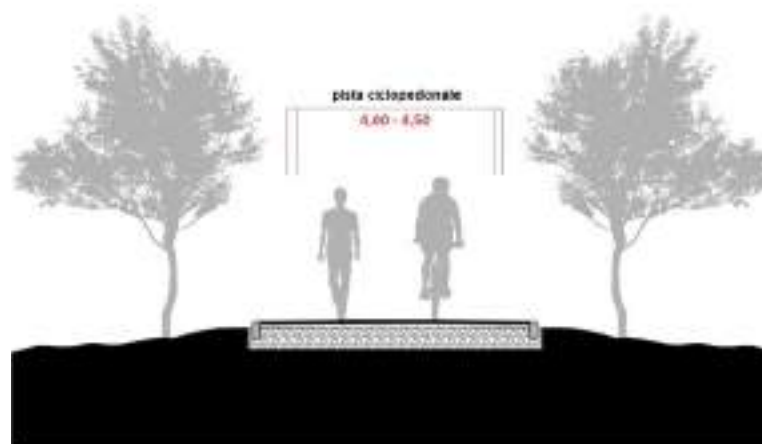
Figura 3.15 - Sezione tipo pista in sede propria non affiancata ciclopedonale
