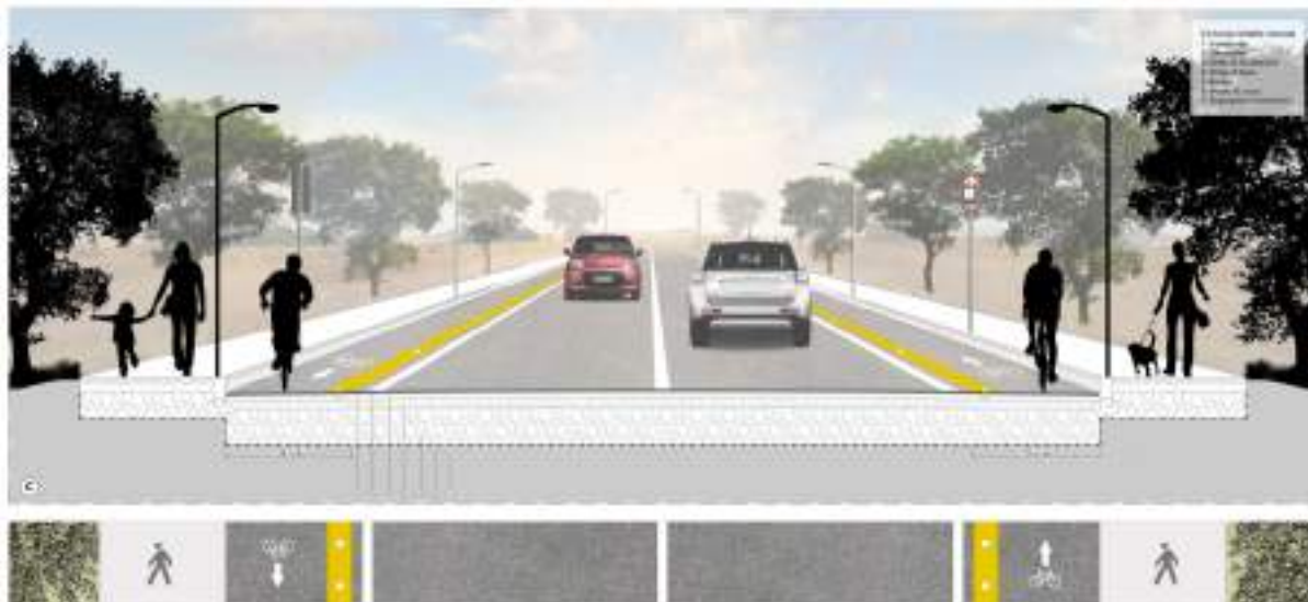
Figura 3.20 - Dettaglio costruttivo corsia ciclabile riservata
