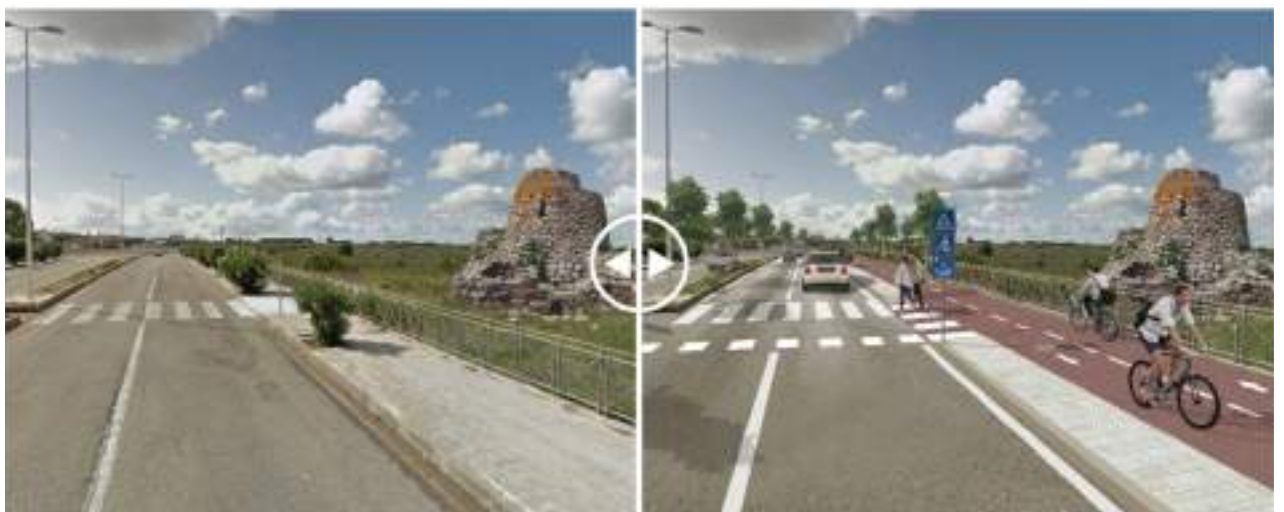
Figura 3.4 - Inserimento pista in sede propria bidirezionale affiancata al marciapiede mediante l'intervento n. 5
