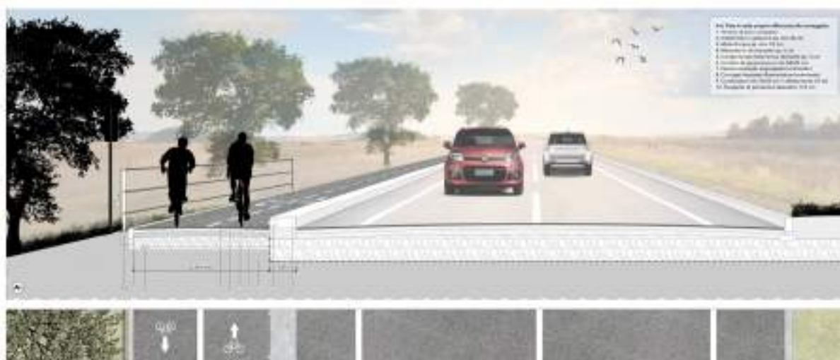
Figura 3.6 - Dettaglio costruttivo pista ciclabile bidirezionale in sede propria affiancata al corpo stradale esistente
