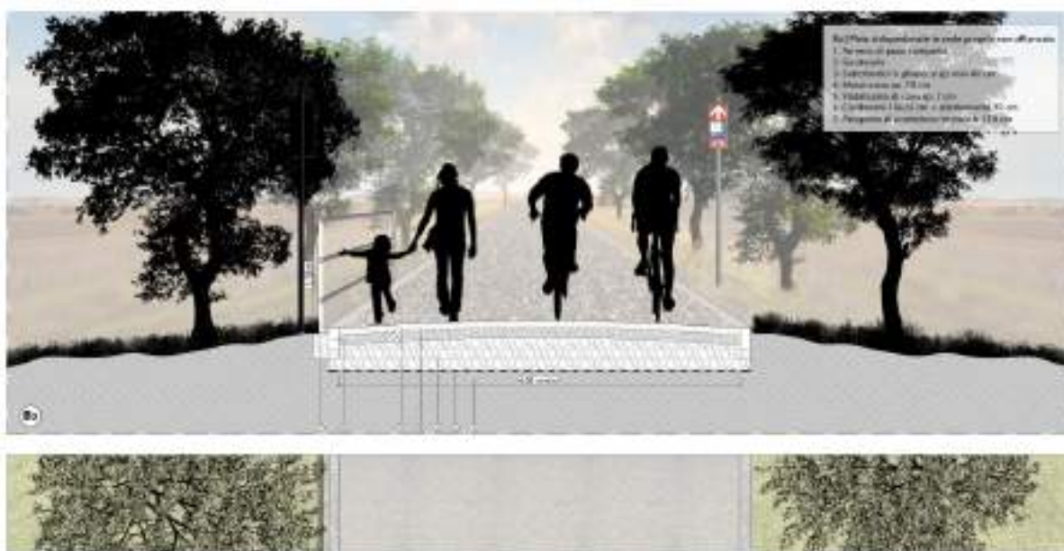
Figura 3.16 - Dettaglio costruttivo pista in sede propria non affiancata ciclopedonale con pavimentazione in stabilizzato misto cava Nella definizione di un itinerario ciclabile in ambito extraurbano, la pista ciclabile e pedonale in sede propria può essere realizzata secondo le seguenti casistiche:
