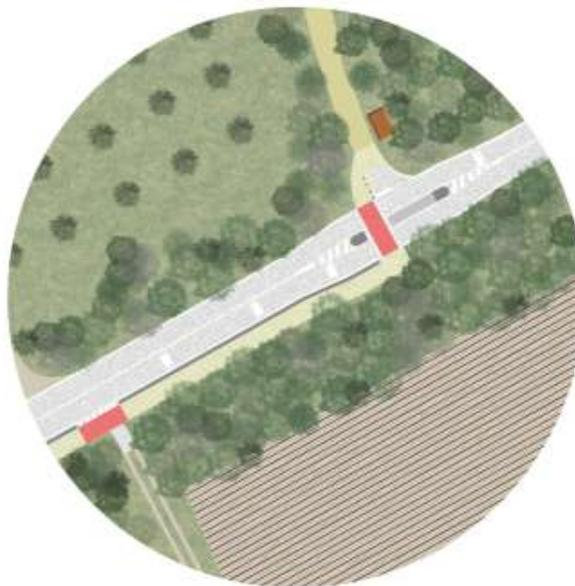
**descrizione:** attraversamento ciclabile della SS292 a connessione di un percorso ciclabile in sede promiscua e una pista ciclabile bidirezionale.
