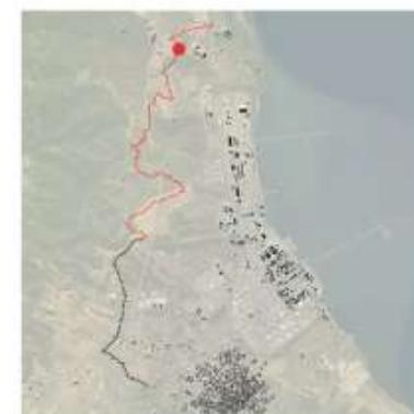
La sezione è tracciata lungo un sentiero carrabile di 3,50 m di larghezza, che consente di evitare il transito all'interno della zona industriale di Sarroch. Per la bassa intensità di traffico si prevede il transito in sede promiscua con i veicoli, attraverso la realizzazione di pavimentazione in stabilizzato misto cava.
