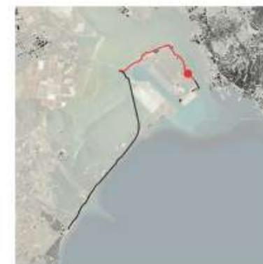
La sezione è tracciata su una strada vicinale lungo canale, caratterizzata da una larghezza media di 3 metri. L'intervento prevede il rifacimento del fondo stradale in stabilizzato misto cava e l'inserimento di barriere di protezione a lato e opportuna segnaletica verticale.
