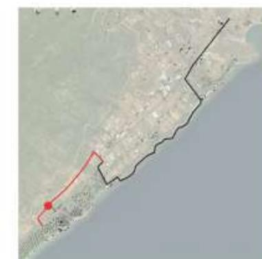
La sezione è tracciata lungo la strada extraurbana via Nuraxeddu, nel comune di Pula. Data la bassa intensità di traffico, l'intervento propone il transito in sede promiscua con i veicoli; si prevede l'adeguamento del fondo stradale tramite la realizzazione di pavimentazione in stabilizzato misto cava.
