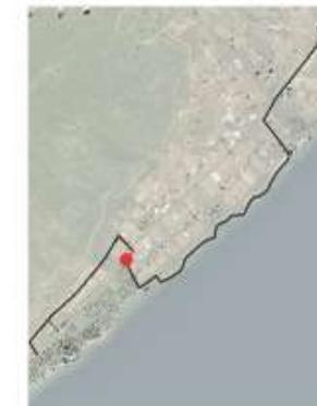
La sezione è tracciata sulla SS195 e prevede l'inserimento della pista sul lato destro piattaforma stradale (direzione S. Margherita-Pula). L'intervento propone la creazione di banchina pavimentata con barriera di protezione laterale.
