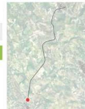
La sezione è tracciata sulla SS197. L'intervento prevede il risistemazione della carreggiata per inserire la pista in sede propria a lato, riducendo il numero delle corsie presenti, reso possibile dall'inserimento della rotondella all'intersezione.
