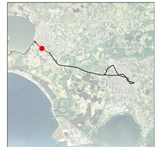
La sezione è tracciata sulla strada arginale che segue il corso del Rio Tanui, nel centro urbano di Cabras. L'intervento prevede la realizzazione di pista in sede propria non affiancata, attraverso la sistemazione del fondo stradale con stabilizzato misto cava e l'utilizzo di barriera laterale di protezione
