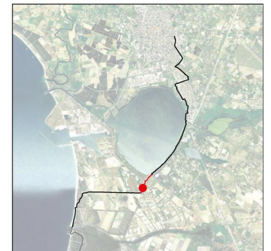
La sezione è tracciata lungo la SP49, nel comune di S. Giusta. L'intervento prevede la realizzazione di pista in sede propria affiancata alla piattaforma stradale, mediante allargamento e pavimentazione della stessa, con previsione di banchina di sicurezza e inserimento di alberatura idonea a fornire ombra lungo il tratto.
