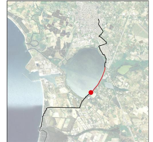
La sezione si trova nell'area verde compresa tra la SP49 e lo stagno di S. Giusta, nell'omonimo comune. L'intervento prevede la realizzazione di pista ciclopedonale in sede propria, ottenuta mediante la definizione di un nuovo tracciato, la sua pavimentazione e l'utilizzo di alberatura idonea a fornire ombra lungo il percorso.
