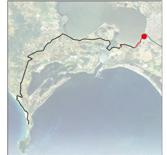
La sezione si trova lungo il sentiero retrostante al Museo Archeologico di Cabras. L'intervento prevede la realizzazione di pista ciclopedonale in sede propria, mediante la sistemazione del fondo stradale con stabilizzato misto cava e l'utilizzo di alberatura idonea a fornire ombra agli utenti che transitano lungo il tratto.
