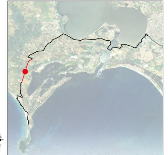
La sezione è tracciata lungo la SP6, strada extraurbana nel comune di Cabras. L'intervento prevede la realizzazione di pista in sede propria affiancata alla piattaforma stradale, attraverso allargamento e pavimentazione della stessa, utilizzo di barriera laterale di protezione e di alberatura utile a fornire ombra lungo il percorso.
