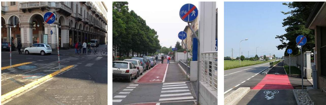
Figura 3.26 - Utilizzo improprio del cartello "Fine pista ciclabile" in corrispondenza di attraversamenti ciclabili o ciclopedonali.
