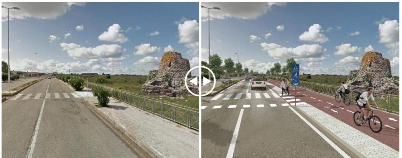
Figura 3.4 - Inserimento pista in sede propria bidirezionale affiancata al marciapiede mediante l'intervento n. 5
