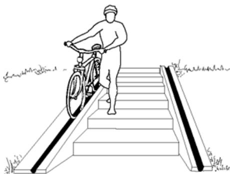
Nel caso di sottopassi e/o sovrappassi esistenti e utilizzati per garantire la continuità di un percorso ciclabile in sicurezza e senza interferenze con il traffico motorizzato, può essere necessario mettere in opera degli interventi di adeguamento per rendere tali strutture idonee anche al transito ciclistico.
