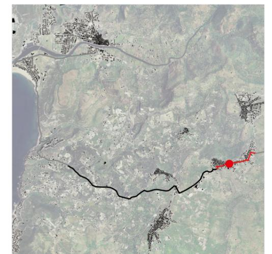
La sezione è situata lungo la via Nazionale, nel centro urbano di Flussio. Si prevede il transito in sede promiscua con i veicoli, tramite l'istituzione di una zona 30 urbana indicata da apposita segnaletica e dall'utilizzo di dissuasori di velocità, oltre alla sistemazione del fondo stradale, in base allo stato di degrado dello stesso.
