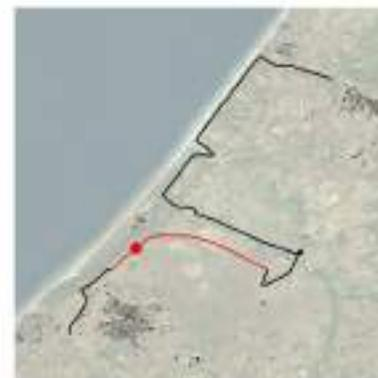
La sezione si sviluppa lungo sentiero carrabile a servizio del canale del Rio Coghinas. L'intervento proposto è la sistemazione della sede stradale, col rifacimento della pavimentazione in stabilizzato misto cava.
