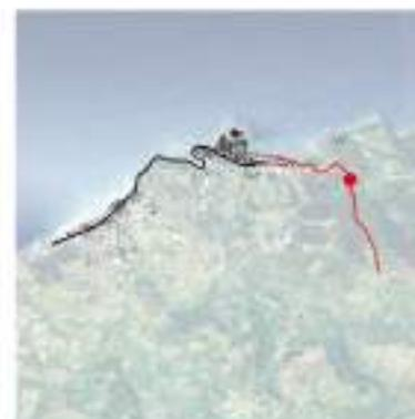
La pista ciclabile in sede propria è posizionata all'interno della piattaforma stradale, risultando in affiancamento alla strada (sopraelevata rispetto al piano stradale). Si sviluppa lungo la SS134 (sul lato destro, direzione Porto Torres-Budesi).
